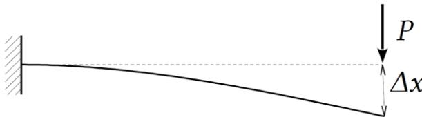
Applichiamo al sistema un carico di prova  $P$  e notiamo una deformazione  $\Delta x = \frac{Pl^3}{3EI}$ . Nel sistema ridotto deve risultare che  $P = k_{eq}\Delta x$ , quindi
